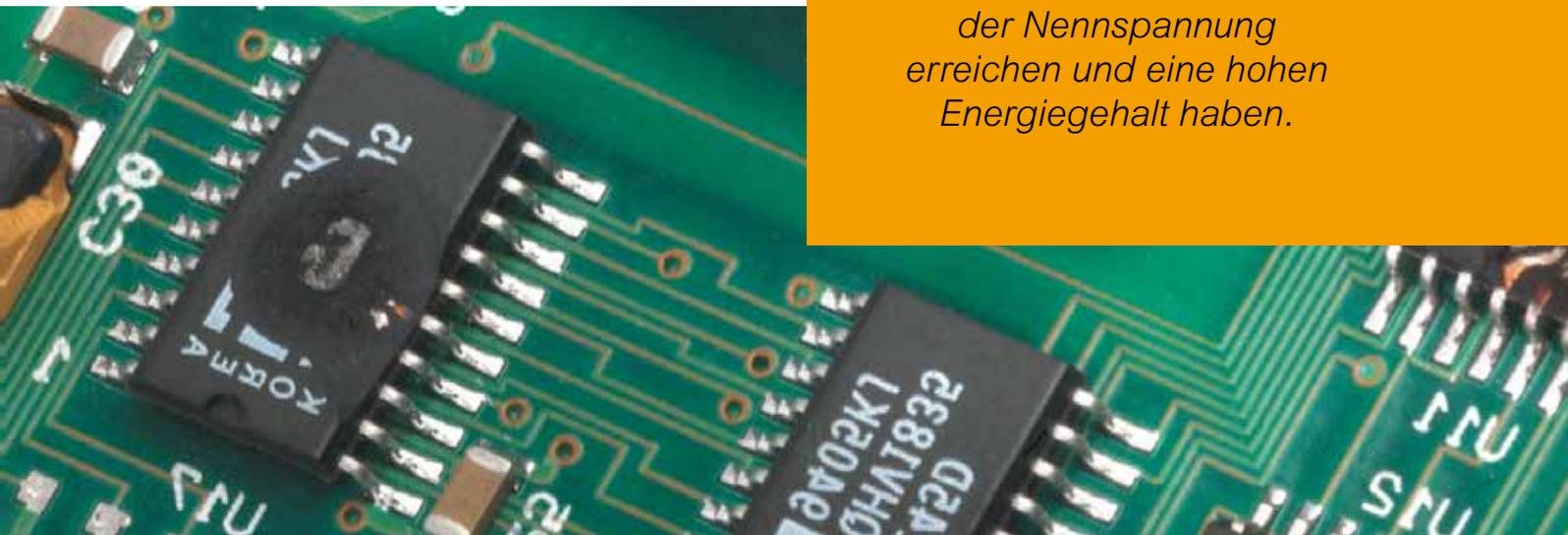
Bild 1.9: Durch Überspannung zerstörte Platine
