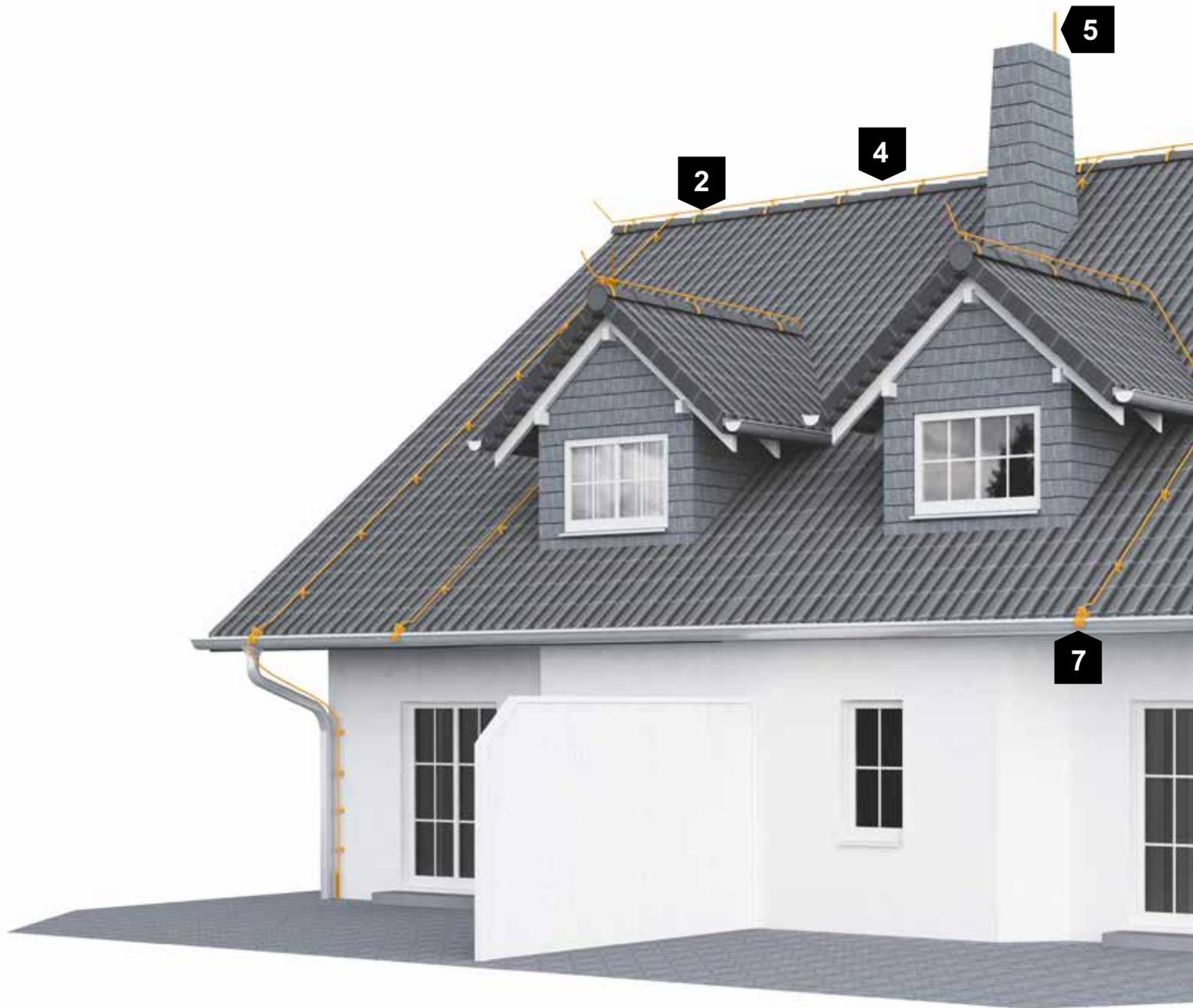
Bild 2.41: Gebäude mit Satteldach und Blitzschutzsystem
