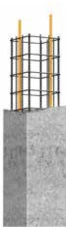
Bild 2.53: Beispiel: Nutzung von bewehrten Betonstützen/ Ableitungseinrichtung
