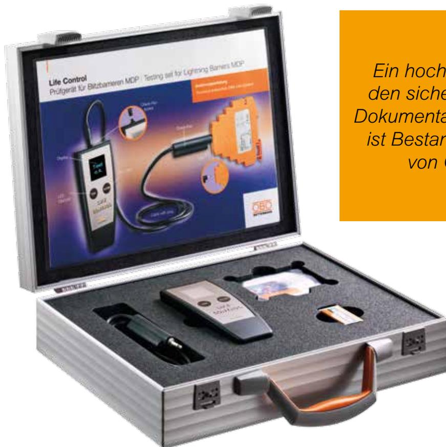
*Ein hochwertiger Prüfkoffer für den sicheren Transport und die Dokumentation der Prüfergebnisse ist Bestandteil dieser Innovation von OBO Bettermann.*
