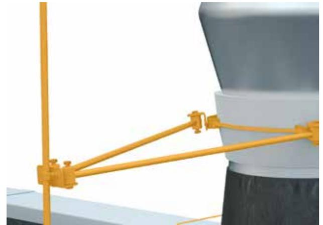
Bild 2.35: Beispiel: Fangsystem mit Iso-Combi-Set für Rohr-V-Befestigung
