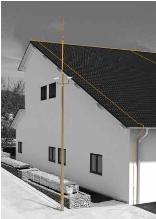
Bild 2.73: Überwachungskamera mit isCon®-Leitung
