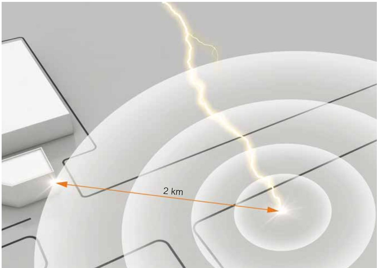
Bild 1.12: Gefährdung: Überspannungsimpuls durch induktive und galvanische Einkopplung
