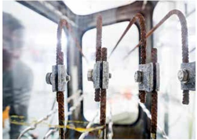
Bild 1.26: BET-SO<sub>2</sub>-Prüfanlage
