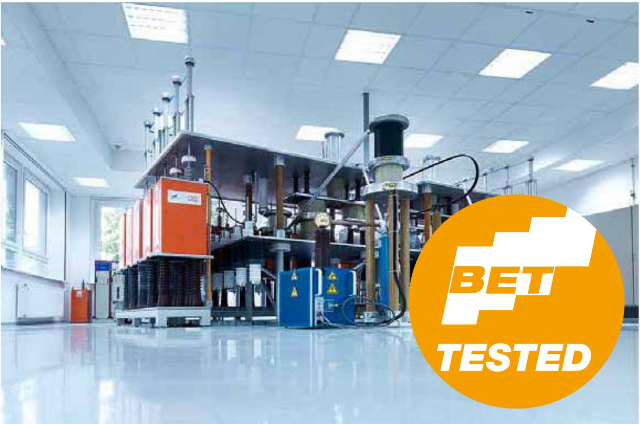
Bild 2.97: BET-Blitzstromgenerator und BET-Prüfzeichen
