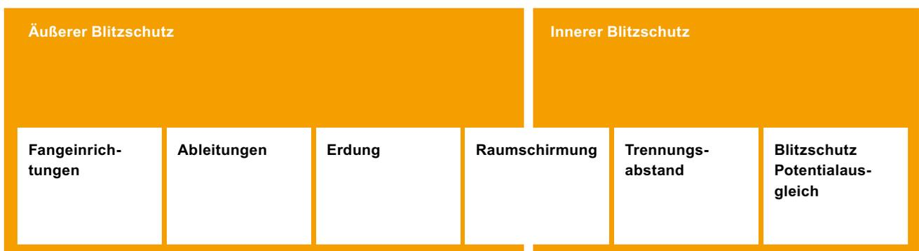
Bild 1.17: Systeme des äußeren und inneren Blitzschutzes
