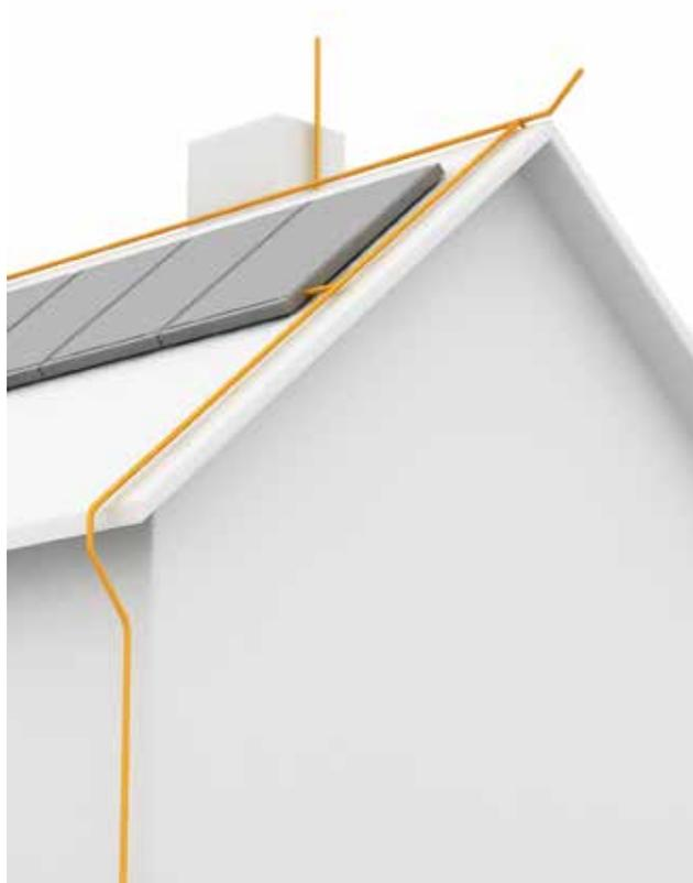
Bild 2.19: Direkter Anschluss der PV-Montagegestelle an die Blitzschutz-Ableitung
