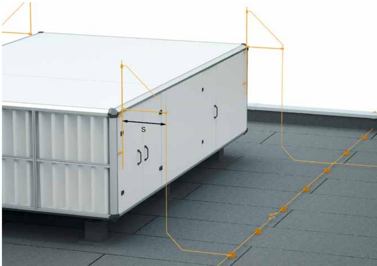
Bild 2.17: Korrekt eingehaltener Trennungsabstand (s) zwischen Ableitungseinrichtungen und Dachaufbauten
