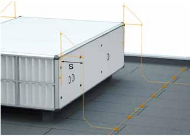
Bild 2.32: Beispiel: Fangsystem mit Iso-Combi-Set für Dreieck-Befestigung
